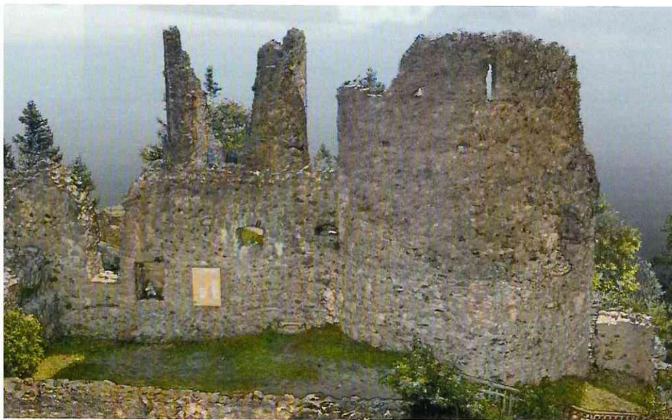
Visualisierung der Ruine mithilfe des 3D Laserscanner Z+F IMAGER 5016. Millimetergenaue Wiedergabe der Realität.
